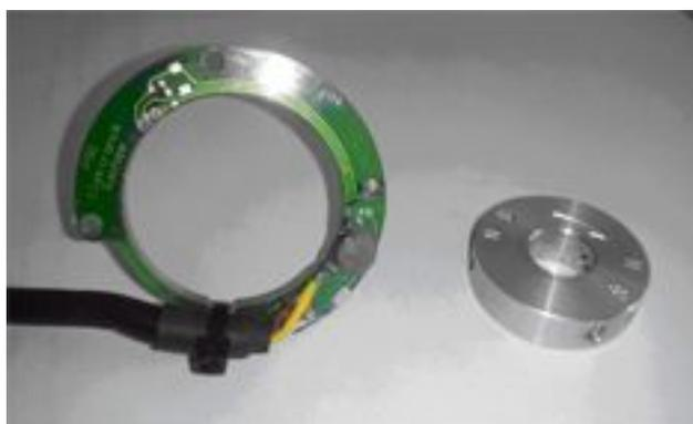
Platine PCB & Rotor à impulsions magnétiques
