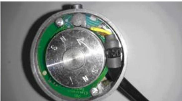
Puis mettre en place et fixer la platine PCB avec son capteur. **Photo 3.** Enfin, insérer le rotor à impulsions sur l'axe d'entraînement sans serrer les vis pointeau du disque. **Vérifier que rien ne vienne freiner la rotation du rotor ( Rilsan du câble électrique par exemple )** **Photo 4**
