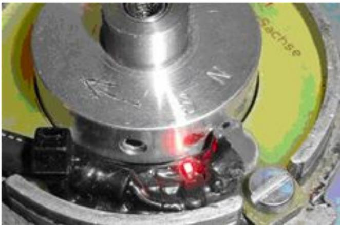
Maintenant, tourner avec précision le disque à impulsions jusqu'à ce que la **marque 'S'** se situe juste avant le capteur. Peu importe quelle paire d'aimants.
