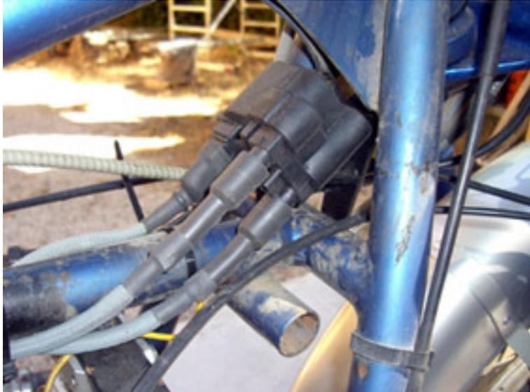
J'ai préféré acheter la bobine électronique à deux sorties, elle n'est pas très volumineuse et on arrive à la loger dans le creux avant du réservoir. J'avais initialement fait un support repris sur le cadre, mais ça butait sur le réservoir. En final, la plaque support a été soudée directement sur la patte du frein de direction, impeccable. Si vous soudez à l'arc, ne pas oublier de faire une détente des soudures avec un chalumeau à gaz (3 à 400°) pour éviter les ruptures dues aux vibrations.
